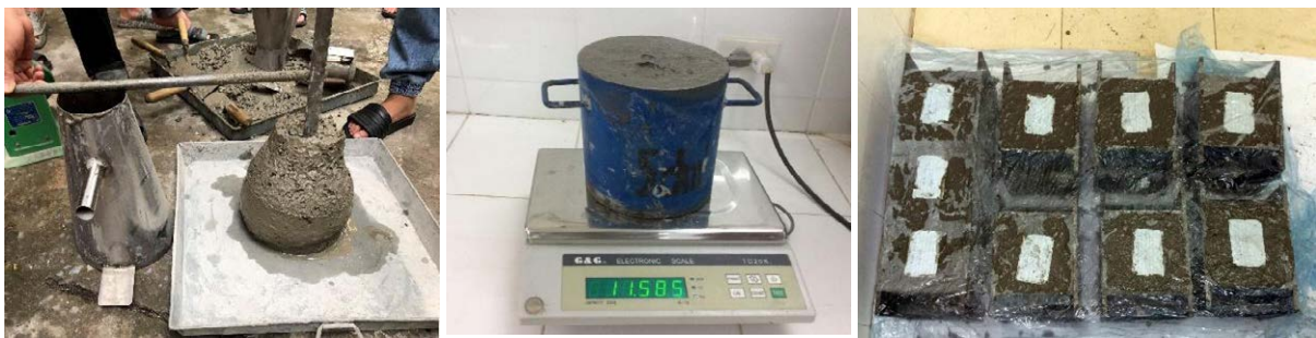
Hình 8: Xác định độ sụt, khối lượng thể tích của hỗn hợp bê tông và đổ mẫu bê tông
